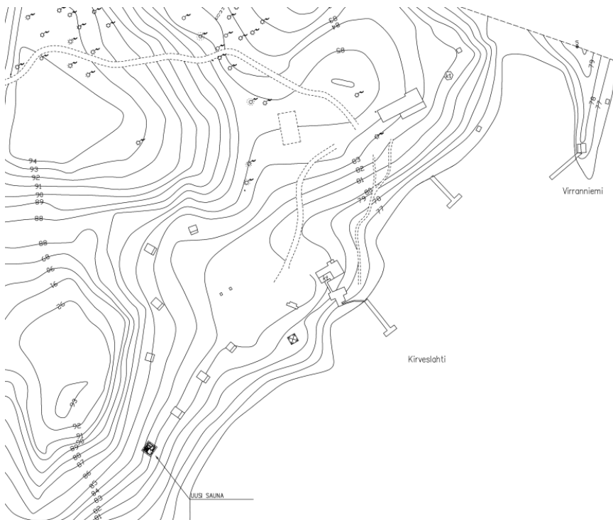
Kuva 10. Asemapiirros, jossa näkyvät vuokramökkit, suurehko päärakennus ja kaksi saunaa rannassa. Alueelle on ollut suunnitteilla myös uusi sauna.
